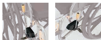
片側のレバー操作で左右同時にブレーキをかけることのできる駐車ブレーキです。操作側(左右)の切り替えは、ネジこみ式のレバーを手で付け替えるだけでできます。
